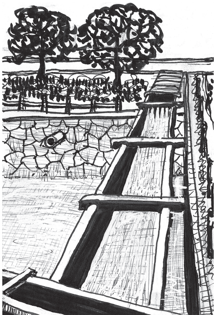
掛樋（水の向きを変える）
