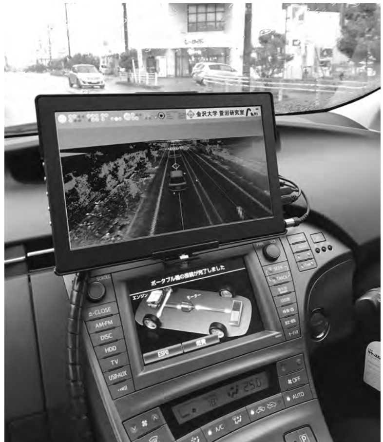
実験車両は、周辺環境認識と自己位置推定を行い、瞬時に軌道を選択する
